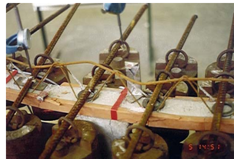
Slika 3. Uzorci ploče - B2 i izdvojene fert gredice -F1, nakon loma Figure 3. Slab specimen - B2 and FERT beam - F1, after failure
