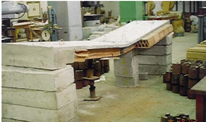
Slika 3. Uzorci ploče - B2 i izdvojene fert gredice -F1, nakon loma Figure 3. Slab specimen - B2 and FERT beam - F1, after failure
