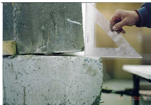
Slika 2. Rotacija oslonačkog presjeka Figure 2. Rotation of the support
